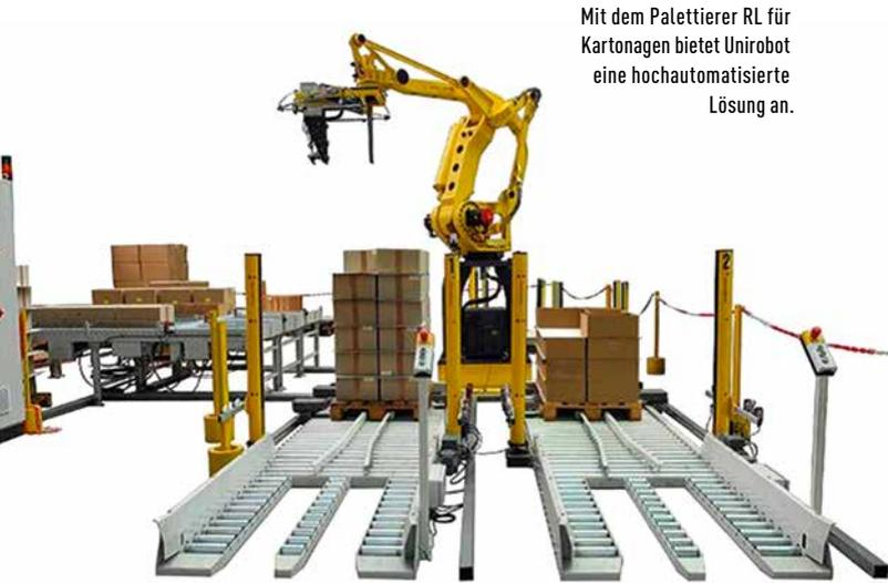
Mit dem Palettierer RL für Kartonagen bietet Unirobot eine hochautomatisierte Lösung an.
